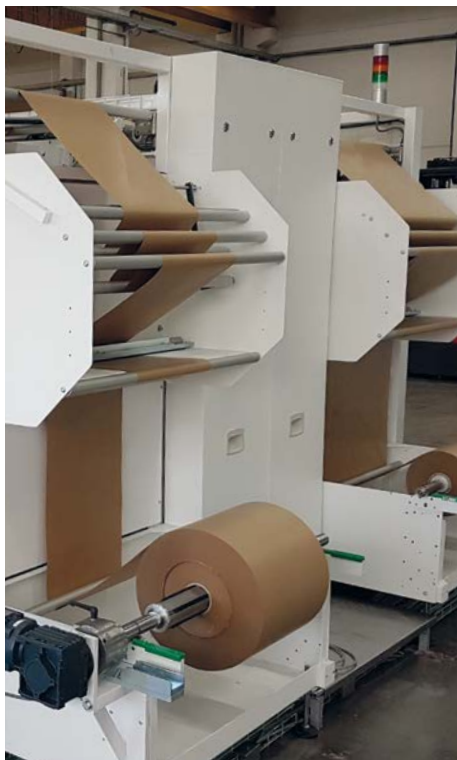
Die Verpackungsmaschine wählt aus unterschiedlich breitem Papier die passgenaue Größe aus
