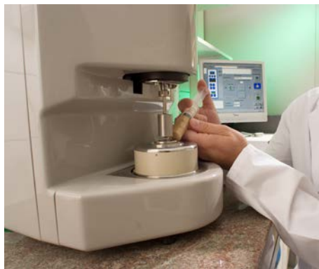
Rotationsrheometer; Bestimmung des Fließverhaltens eines keramischen Schlickers
